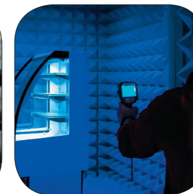
Sala de medición y calibración acústica.
